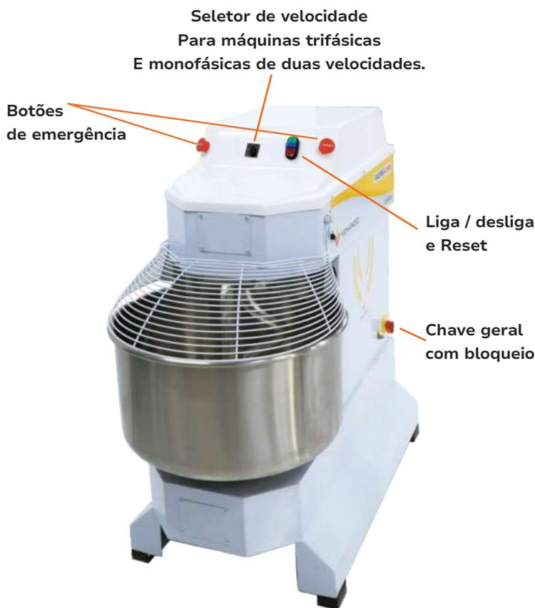
As espirais de 25 kg possuem produção mínima de 12 kg de massa pronta, ou seja utiliza 5 kg de farinha, já a capacidade máxima de massa pronta é 25 kg, utilizando 16 kg de farinha.
